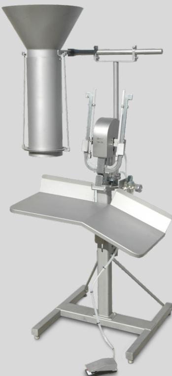
Упаковочная машина УМ-1П предназначена для одновременного запечатывания конца предыдущей и начала следующей дозы продукта колбасными клипсами. Подходит для клипсования сельскохозяйственной продукции (овощей, фруктов, орехов и др.) в пакеты, рукавные и сетчатые оболочки с одновременным разрезанием перемычки между клипсами.
